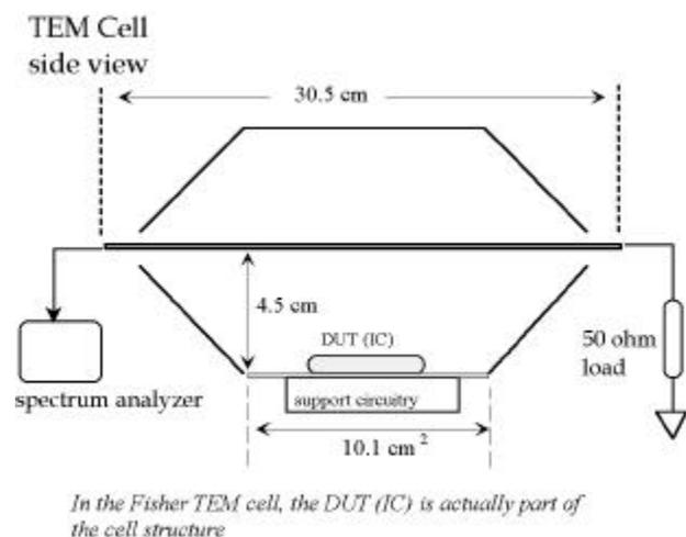
Figure 1 SAE IC TEM cell
